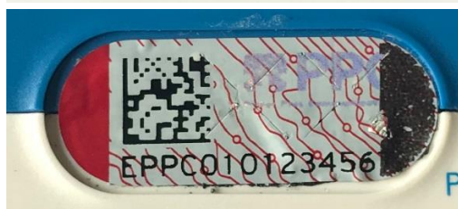
Abbildung 6: Zustände des Siegels des Smart Meter Gateways
