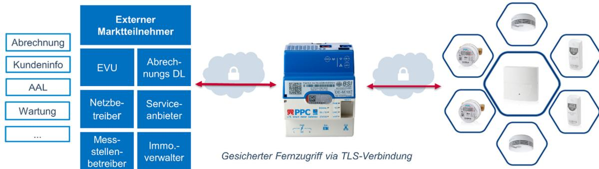
Abb. 1: Das Smart Meter Gateway ermöglicht die sichere Anbindung von Submetering und smarten Diensten.
