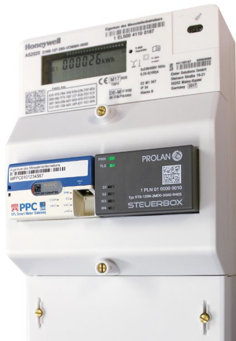
Abb.1: Das Smart Meter Gateway von PPC wird über seine CLS-Schnittstelle mit der Prolan Steuerbox verbunden
